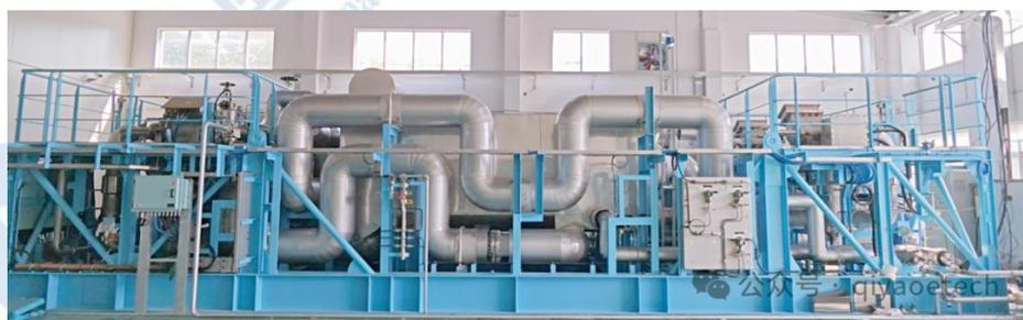
“LNG 深冷式再液化装置”是 LNG 加注运输船液货系统的核心设备,其利用氮氦压缩膨胀所产生的冷量将 LNG 深冷后喷淋回舱来实现蒸发气体 (BOG) 的再次平衡液化,既能避免 BOG 直接燃烧排放造成的经济损失和温室危害,又能保证液货舱内的温度、压力处在合适的范围内,从源头上降低 BOG 产生,具有稳定高效、安全可靠、长周期免维护等优势。
